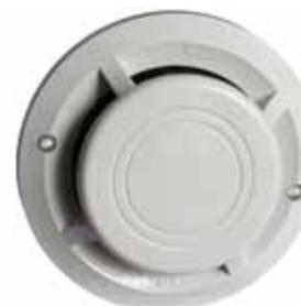
У LZR-1 и FX NET есть функция автоматической лазерной группы. Замеры, полученные лазерными извещателями, которые установлены в одной зоне обнаружения, учитываются при обнаружении пожара. Если несколько лазерных извещателей в одной группе определяют повышенный уровень задымления, FX NET формирует тревогу ещё до того, как отдельные извещатели достигнут своих порогов тревоги. Таким образом, ранее оповещение сработает ещё быстрее.
