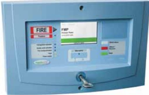
Выносная панель управления FMP2/RU используется пожарной бригадой как основной источник информации о месте срабатывания сигнализации в здании. Панель можно использовать исключительно как дисплей, а также для выключения и сброса пожарной сигнализации. Если требуется только выводить информацию по пожарной сигнализации в зоне, панель FMP2/RU нужно соответствующим образом настроить. Панель FMP2/RU можно подключать к панелям FX 3NET: FXS, FXM, FX и FXL.
