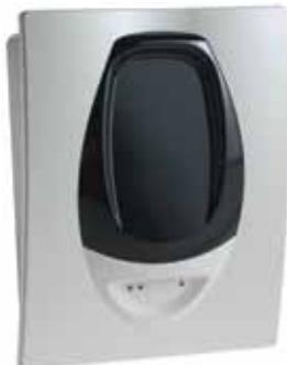
Извещатели 6500SA и 6500A – приёмопередатчики, которые можно подключить непосредственно к шлейфу. Инфракрасный передатчик генерирует луч света, направленный к высокоэффективному отражателю. Отражатель возвращает луч приёмнику, в котором проводится анализ полученного сигнала. Изменения уровня отраженного сигнала используется для формирования сигнала тревоги.
