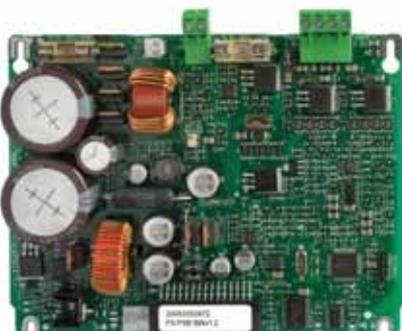
**Источник питания PSB предназначен для панелей FX и FXL.**
