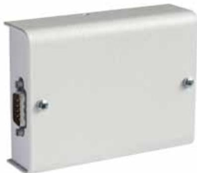
Модемный адаптер CODINET используется вместе с модемом для организации связи через последовательный порт на большие расстояния. Стандартное расстояние между двумя локальными модемами может составлять 1-5 км. Адаптер CODINET рассчитан на передачу данных со скоростью 19200 бод и имеет гальваническую развязку.
