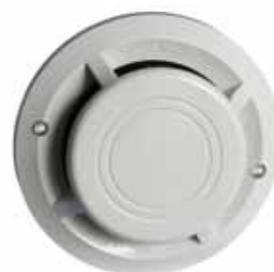
Высокая чувствительность лазера достигается за счёт комбинации запатентованной оптической камеры с новейшим лазерным диодом и оптической технологии наивысшей точности. Благодаря этому лазерный извещатель до 100 раз чувствительней стандартных оптоэлектронных извещателей, и его можно установить на определение затемнения 0,07... 6,56% на 1 метр.
